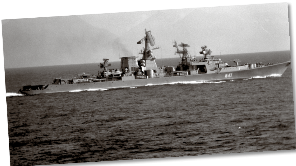
Sõjalaev „Tallin“. Suur allveelaevahävitaja, praktiliselt allvee- ja õhutõrjeristleja, pikkus 173,4 m, veeväljasurve (maksimaalselt) 8533 tonni, kiirus 32 sõlme (s.o ligi 60 km/h), meeskond 380 inimest. Laeva ehitamist alustati aastal 1975, Nõukogude sõjalaevastiku koosseisu arvati see 31.12.1979, vanarauaks lõigati 1997. (Vikipeedia)
